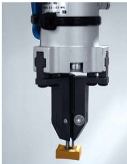
Mit automatisch wechselbaren Greifern kann ein breites WSP-Produktspektrum flexibel abgedeckt werden.
