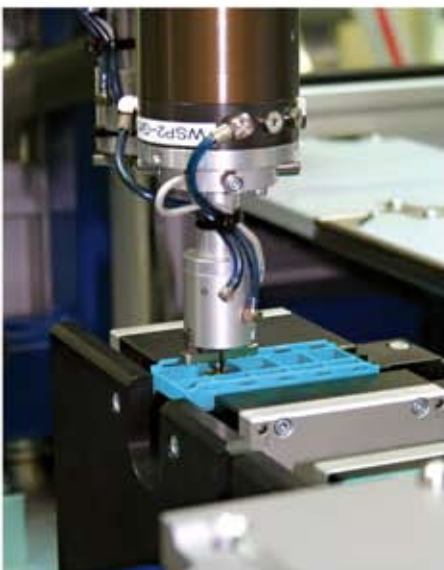
Nach Prüfung und Kennzeichnung werden die Wendschneidplatten fertig in Verkaufspackungen verpackt.
